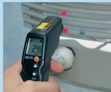
Spolehlivá měření díky zaměření laserovým paprskem
